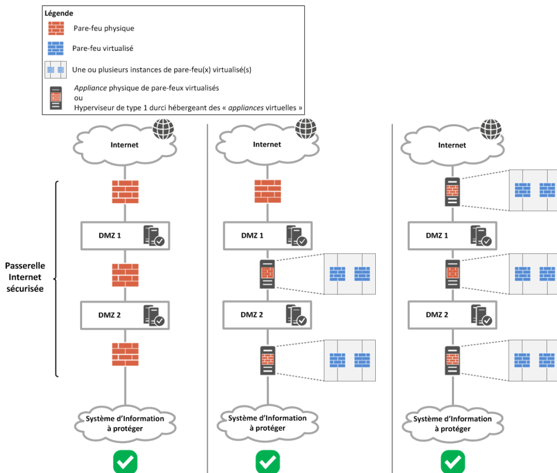
FIGURE 4.2 – Passerelles sécurisées complexes : exemples d'architectures possibles
