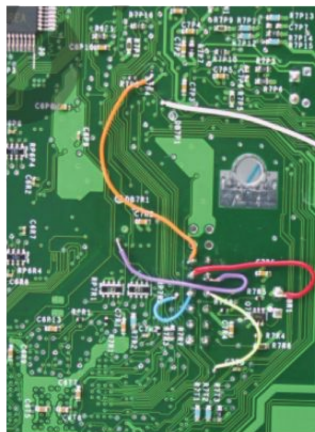
Figure 14. Xbox : reconstitution du port LPC sur une Xbox version 1.6
