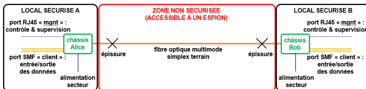
Figure 1 : schéma de déploiement du produit, avec les différentes interfaces des deux châssis et la fibre optique multimode terrain du client.
