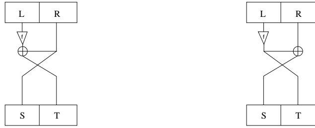
FIGURE 1.4: Schémas Misty L (à gauche) et Misty R (à droite). Message d'entrée [L, R] , message de sortie [S, T] .
