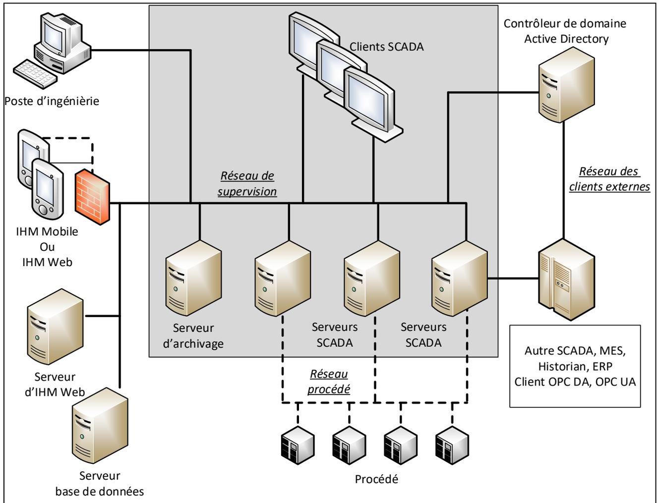
FIGURE 3 – Architecture Client-Serveur, réseau procédé séparé
