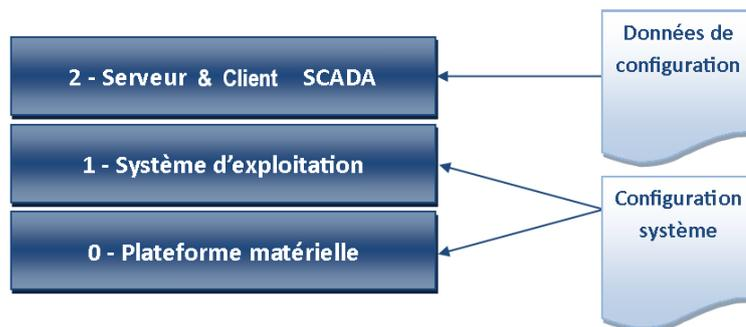
FIGURE 2 – Modélisation d'un système de supervision industrielle
