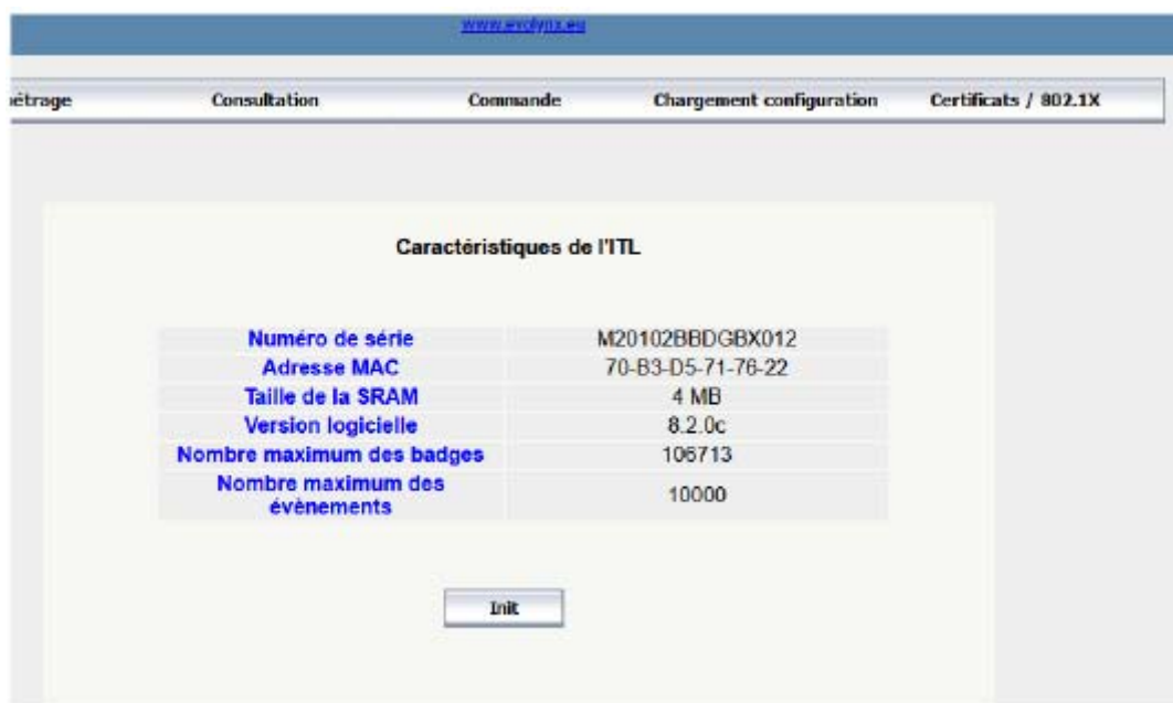
Figure 4 : Affichage de la version du firmware ITL depuis le serveur web embarqué
